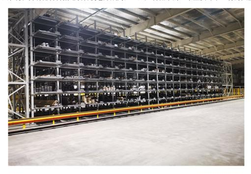
折叠立体仓库按功能分类1)储存式立体仓库,以大量存放货物为主要功能,货物种类不多,但数量大,存期较长。各种密集形货架的立体仓库都适于做储存式仓库。2)拣选式立体仓库,以大量进货,多用户、多种类、小批量发出为主要功能的立体仓库。这类仓库要创造方便拣选和快速拣选的条件,因此,往往采取自动寻址认址的方式。由于用户需求差异较大,难以整进整出,因此,不适合用自动化无人作业方式,而使用人工拣选。拣选式立体仓库较多用于配送中心。青海大型立体仓库货架:用于存储货物的钢结构。主要有焊接式货架和组合式货架两种基本形式。
