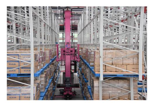
自动化立体仓库的优缺点自动化立体仓库的突出的特点就是提高了垂直空间利用率,充分诀曰有限且宝贵的徒弟。现在提高空间利用率的观点已有更深刻的含义,节约土地,已与节约能源、环境保护等更多的方面联系起来。比如自动化立体仓库的基本建设费用、照明费用、供暖费有一般都会比普通仓库节约2-3倍。通常来说,自动化立体仓库其空间利用率为普通平库的4-7倍。目前,世界上比较高的立体仓库可达40多米,容量多大30万个货位。采用计算机、进行仓储管理,可以方便地做到"先进先出",并可防止货物自然老化、变质、生锈,也能够避免货物的丢失。货位集中,便于控制与管理,特别是使用电子计算机,不但能够实现作业的自动化控制,而且能够进行信息处理。能更好地适应黑暗、低温等特殊环境的要求。例如,胶片厂把胶片卷轴存放在自动化仓库里,在完全黑暗的条件下,通过计算机控制可以实现胶片卷轴的自动入库。按结构形式分为单立柱和双立柱两种基本形式;按服务方式分为直道、弯道和转移车三种基本形式。青海大型立体仓库
